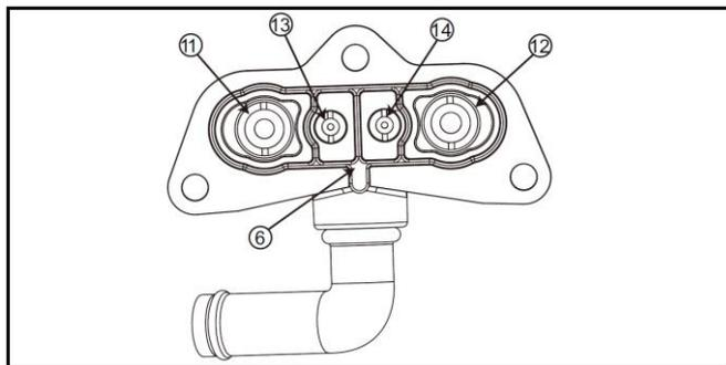
5. Установить камеру впуска топлива на корпус смесителя. Затянуть винты камеры впуска топлива (3). Момент затяжки винтов: 2,94 Нм.
