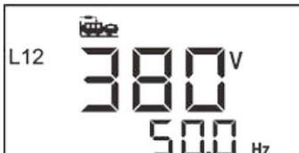
Питание от генератора: линейное напряжение L31, частота F
