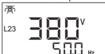
Питание от генератора: линейное напряжение L12, частота F
