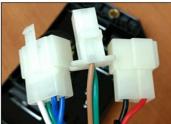
1. **Разъем №1** (крайний слева) имеет 4 вывода. Два провода на правой стороне разъема (вверху и внизу) - СИНИЕ. Они идут к обмоткам возбуждения на статоре. Два провода с левой стороны разъема (вверху и внизу) - ЗЕЛЕНый (вверху) и БЕЛый (внизу) идут к силовым обмоткам статора.
